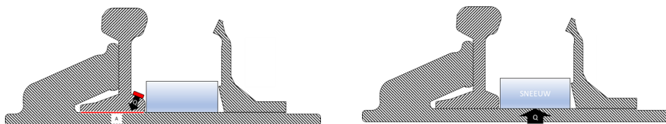
Figuur 7. Het linker plaatje toont wisselverwarming met elektrisch lint. Dit lint (rood vlakje) verwarmt de spoorstaaf.
