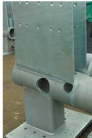
3. De flexibele aansluitplaten in de fabriek.
