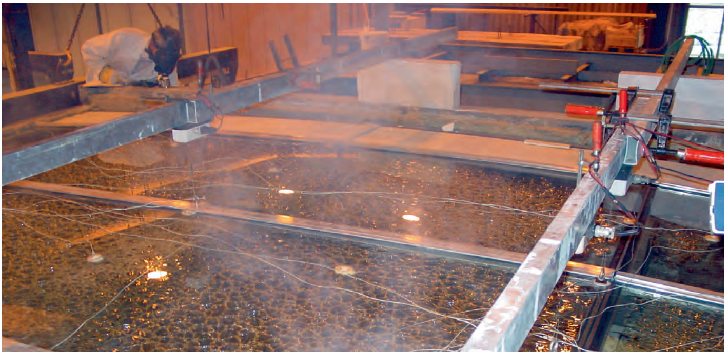
9. De brandproef na 20 minuten. Duidelijk zichtbaar is de verkleurde, zachtborrelende kunststoffolie.
