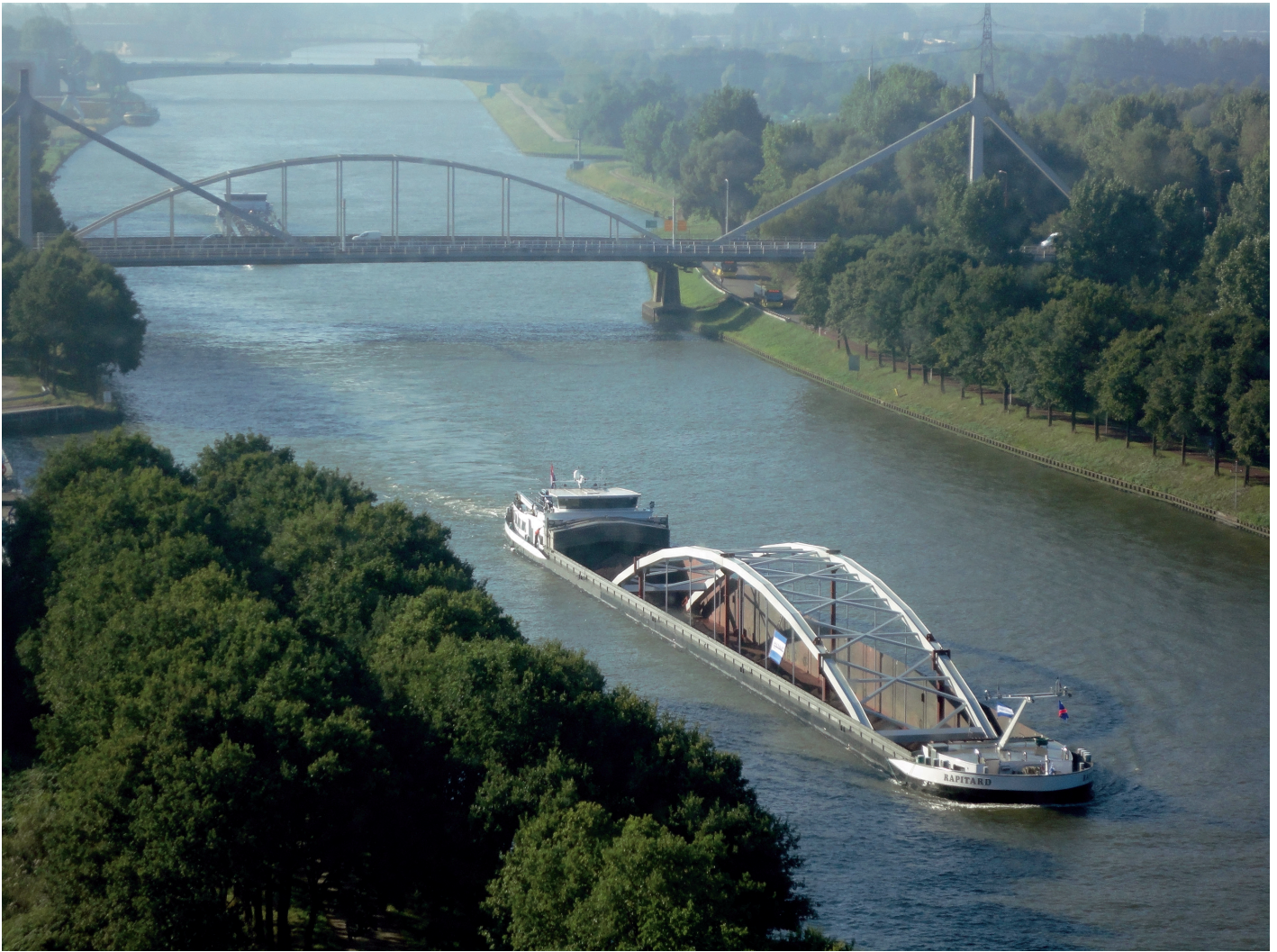
De boogconstructie (125 ton) wordt vervoerd met een binnenvaartschip, verzwaard met 2100 ton ijzererts en 1320 ton water voor juiste diepgang.
